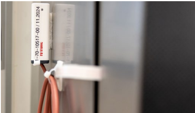
Un mini data logger in uso per una cabina di riscaldamento Thommen Medical: per un uso ottimale, il sensore interno è stato collegato al data logger con un cavo a nastro.
