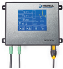
Michell Optidew 501 Taupunktspiegel-Hygrometer
