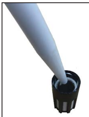
Abbildung 29 Reinigung des Filterelements
