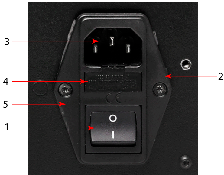
Abbildung 26 Austausch der Sicherung der Netzversorgung
